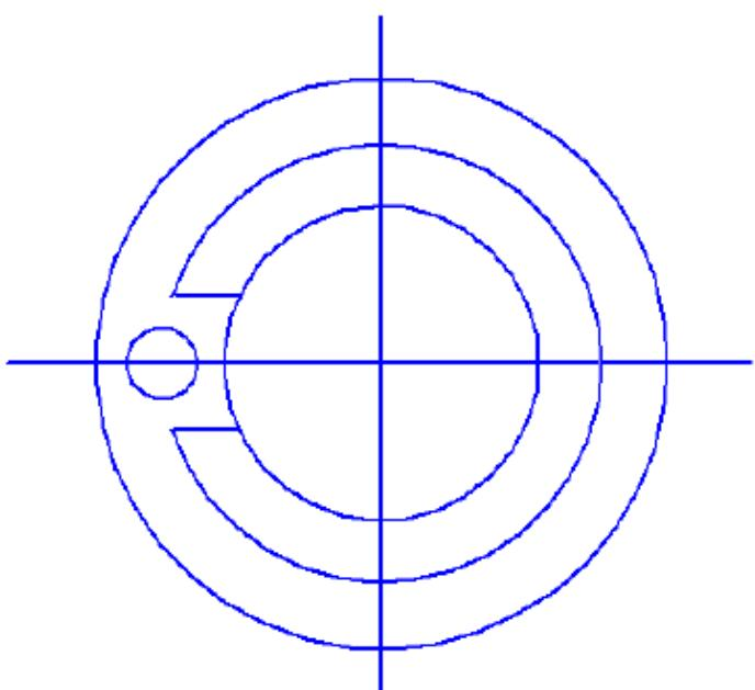
Рис. 2.11. Обрезка концов отрезков и дуг окружностей
