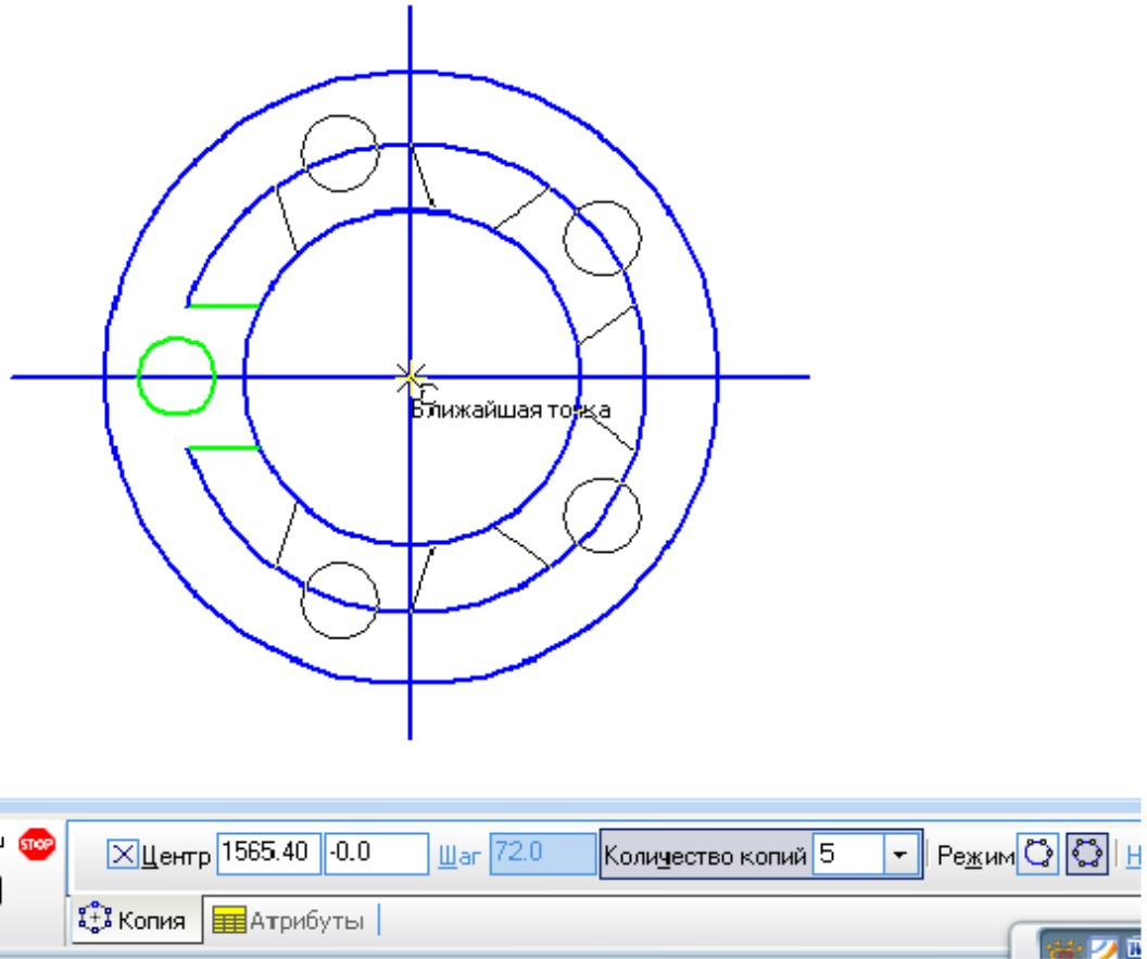
Рис. 2.12. Построение массива элементов
