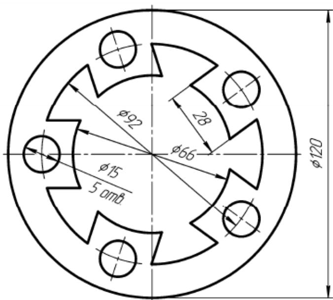
Рис. 2.8. Деталь с повторяющимися по окружности элементами
